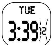
Oprima repetidamente el botón **MODE** hasta que aparezca la abreviatura TME [FECH Y HOR], después de lo cual aparece la fecha y la hora. Despues mantenga oprimido el botón **SET/LIGHT/STP/RST.** durante 3 segundos aproximadamente. En seguida destellan los dígitos de los segundos.
